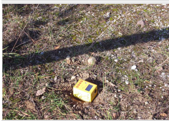
FIG. 19: INDAGINE SISMICA PASSIVA CON TROMINO
